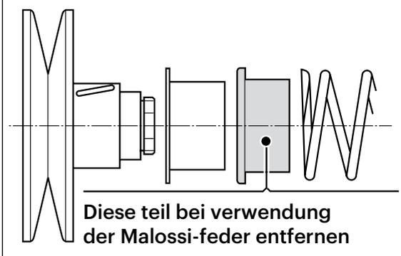
Diese teil bei verwendung der Malossi-feder entfernen
