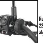
Remova os parafusos do quadro e conecte a alça. Se o diâmetro da alça for de 22 mm, use as almofadas antiderrapantes fornecidas para a alça de 22 mm. As alças de 25,4 mm não requerem almofadas antiderrapantes. Se o diâmetro da fixação for superior a 25,4 mm, não poderá ser montada na alça. Instale a fixação com o ângulo mostrado na figura.
