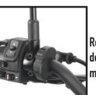
Retirar los pernos del soporte y acoplar el mango. Si el diámetro del mango es de 22 mm, utilizar las almohadillas antideslizantes incluidas para mangos de 22 mm. Los mangos de 25,4 mm no necesitan almohadillas antideslizantes. Si el diámetro de la fijación es superior a los 25,4 mm, no se puede montar en el mango. Instalar la fijación con el ángulo que se indica en la figura.
